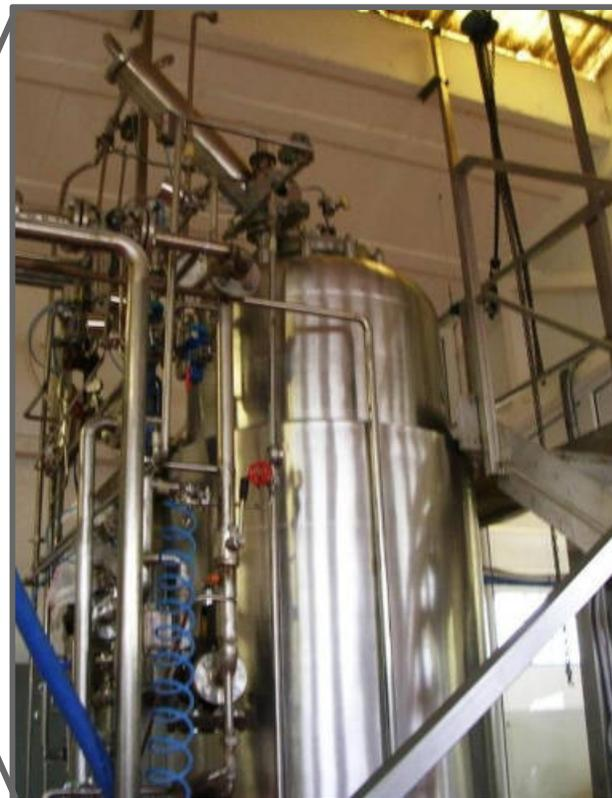
In queste fasi, si opera ovviamente in **condizioni di assoluta sterilità e tutte le condizioni di crescita (pH, temperatura,...) sono controllate**
